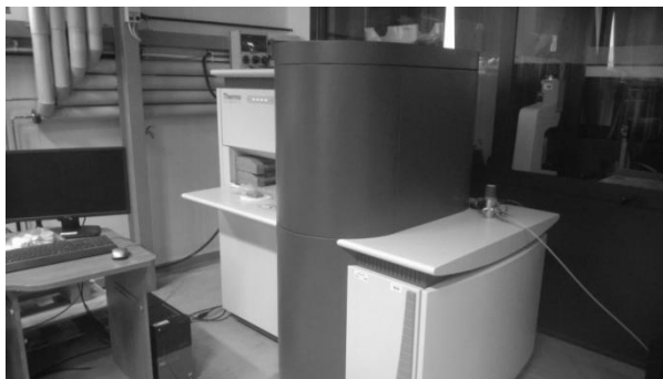
Rysunek 8. Fotografia spektrometru K-Alpha firmy Thermo Scientific znajdującego się w Laboratorium Międzyuczelnianym w Stalowej Woli. Zdjęcie wykonane przez autora pracy
