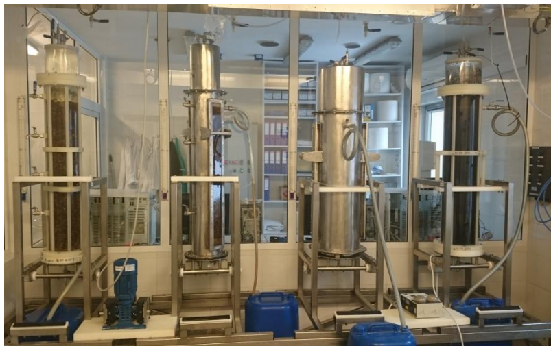
Rysunek 5. Dwuetapowa instalacja produkująca biowodór i biometan po 20-krotnym przeskalowaniu (KSC S.A. o/Cukrownia Dobrzelin) [opracowanie własne]
