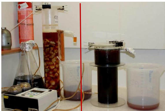
Rysunek 4. Dwuetapowa instalacja produkująca biowodór i biometan w skali laboratoryjnej (IBB PAN) [opracowanie własne]
