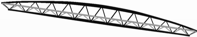
Rysunek 6. Wstępna imperfekcja geometryczna kratownicy
