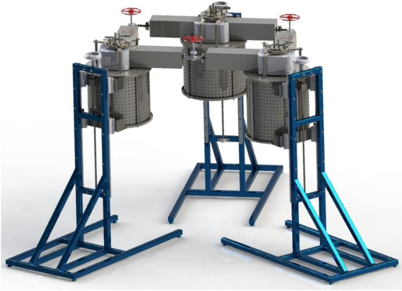
Rysunek 20. Modelu 3D prototypu reaktora CCMS wraz z konstrukcją nośną [opracowanie własne]
