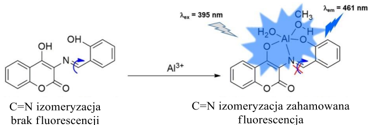
Rysunek 2. Sonda fluorescencyjna na bazie kumaryny do wykrywania jonów glinu oraz obrazowania komórek nowotworowych; źródło [16]
