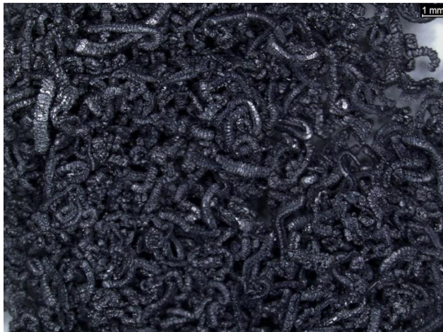
Rysunek 1. Niesprasowany EG zobrazowany za pomocą mikroskopu optycznego, z uwidocznieniem robakowatej/akordeonowej mikrostruktury pojedynczych płatków [opracowanie własne]
