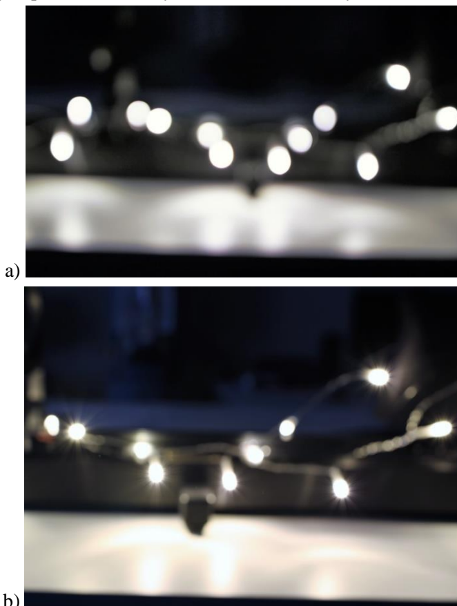
Rysunek 13. Testy rozmycia studyjnego obiektywem fotograficznym 21 mm, a) zdjęcie wykonane obiektywem z przysłoną ustawioną na T1.5, b) zdjęcie wykonane tym samym obiektywem z wartością przysłony T4.0 [opracowanie własne]
